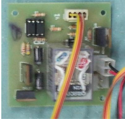
Gambar di samping merupakan driver motor DC yang akan mengendalikan kecepatan putar dan arah putar motor DC. Driver motor ini menggunakan sistem relay.
